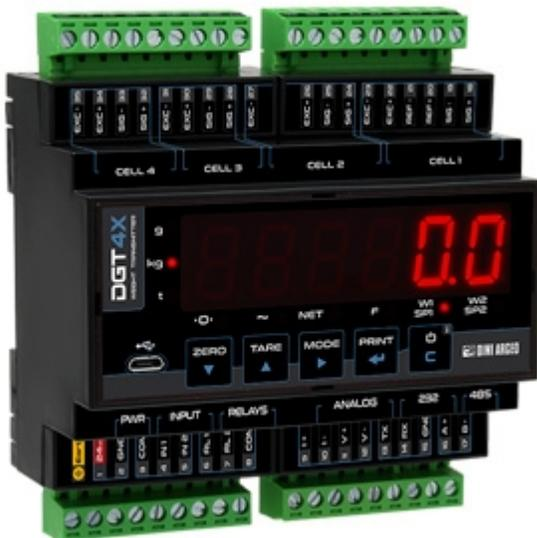
Transmisor de peso digital diseñado específicamente para su uso con básculas puente digitales y pesaje en silos. Integra funciones de direccionamiento de células de carga, sustitución rápida, ecualización y calibración.
